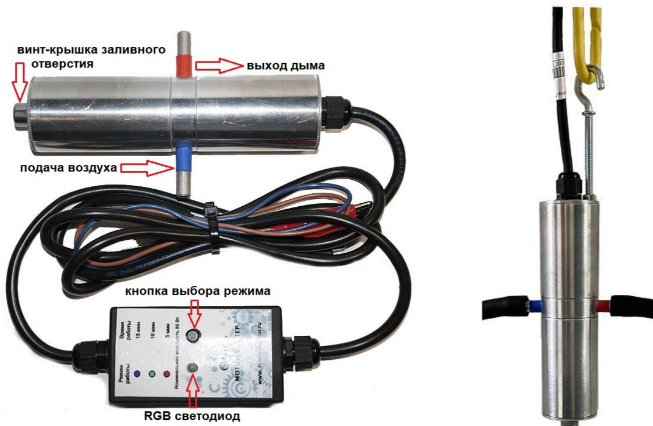
Электронный блок-таймер специально разработан для защиты устройства от неправильного подключения и контроля времени работы свечи накала, установленной в модуле-испарителе. Встроенный микроконтроллер позволяет управлять временем работы свечи в зависимости от выбранного режима (5, 10, 15 мин).
