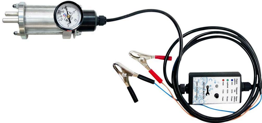
Электронный блок-таймер специально разработан для защиты устройства от неправильного подключения и контроля времени работы свечи накала, установленной в модуле-испарителе. Встроенный микроконтроллер позволяет управлять временем работы свечи в зависимости от выбранного режима (5, 10, 15 мин).
