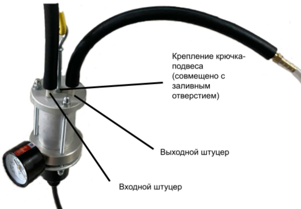
К входному штуцеру подключите источник сжатого воздуха, через прилагаемый в комплекте резиновый шланг (20 см) и быстросъемный разъем-переходник для гаражного компрессора, имеющего регулятор выходного давления и манометр.
