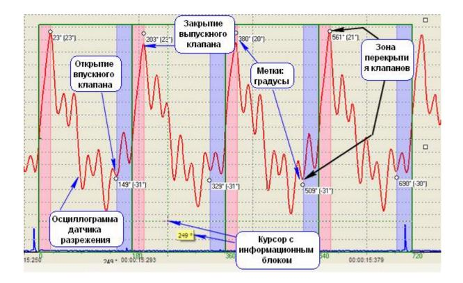
Поступление новой порции топливовоздушной смеси в цилиндр четырёхтактного двигателя осуществляется через канал открытого впускного клапана, соединяющего внутренний объём впускного коллектора двигателя с внутренним объёмом цилиндра. Перетекание топливовоздушной смеси из впускного коллектора в цилиндр происходит за счёт разрежения создаваемого движущимся вниз (от головки блока цилиндров) поршнем.
